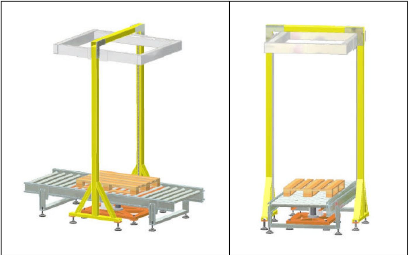
La macchina è costituita da due colonne sulle quali scorre un quadrilatero con i sensori di misura. Il pallet viene arrestato nel punto di misura; il quadrilatero si abbassa fino ad allineare le fotocellule di misura al pallet. Il quadrilatero inizia a sollevarsi per eseguire la scansione del profilo del prodotto sul pallet.
