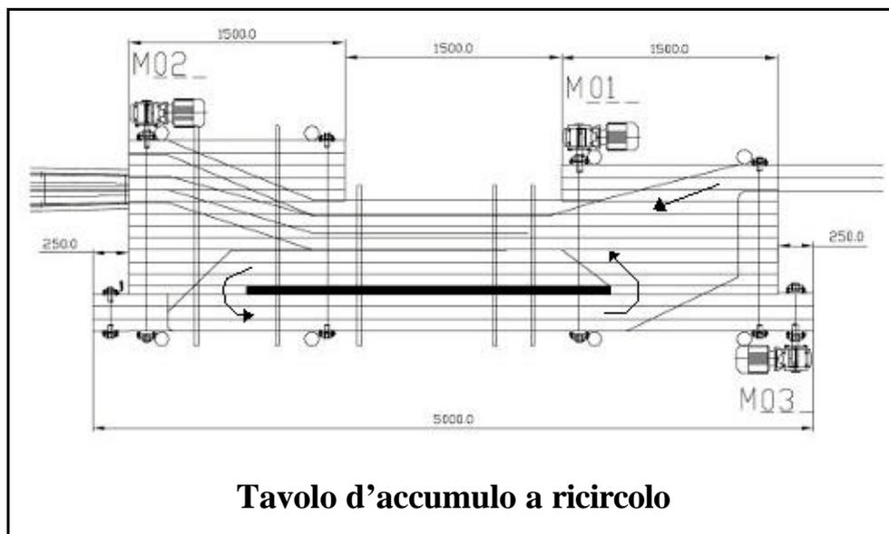
La struttura del trasportatore può essere realizzata in acciaio verniciato, zincato o inox.
