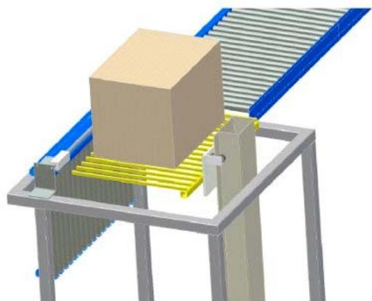
Con l'abbassarsi del supporto a griglia, il prodotto viene appoggiato sulla rulliera rotante. La rulliera superiore è motorizzata per portare il prodotto all'esterno della macchina. La macchina base ha la sola rulliera rotante: su deve prevedere all'esterno un altro nastro folle o motorizzato per l'evacuazione dei colli. Un portello di sicurezza chiude la parte superiore dell'elevatore e si apre solo prima dell'espulsione del collo.
