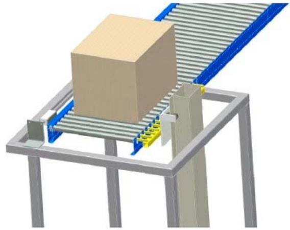
Durante l'uscita del prodotto, il supporto a griglia si abbassa per ritornare nella posizione inferiore, all'interno della rulliera inferiore.
