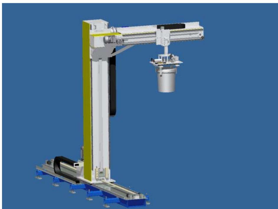
Il pallettizzatore cartesiano aperto è un robot cartesiano serie CC a 3/4 assi con un asse a terra che può arrivare a 10 metri di corsa, per pallettizzare fino a 7 posti pallet. Questa macchina è priva di un telaio perimetrale che è invece presente nei pallettizzatori della serie PCC e PCS.
