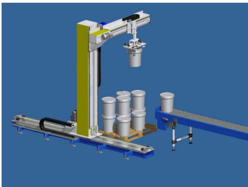
L'asse Y a fianco ha una corsa di 1250 mm che consente di pallettizzare su di un europallet posizionato trasversalmente. Qualora vi sia la necessità di scavalcare un pallet completo con il prodotto, la corsa può essere incrementata di 400mm per consentire di portare la pinza con il prodotto allineata con la trave verticale e quindi fuori dell'ingombro del pallet completo.
